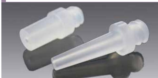
Permet de fixer une pointe 200 µl ou 1000 µl sur le cône Luer d'une seringue.
