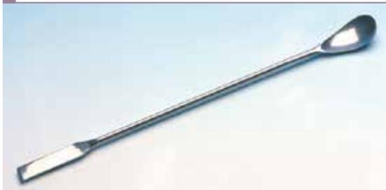
Une des extrémités est rectangulaire et plate, l'autre en forme de cuillère. Deux longueurs : 235 mm et 500 mm.
